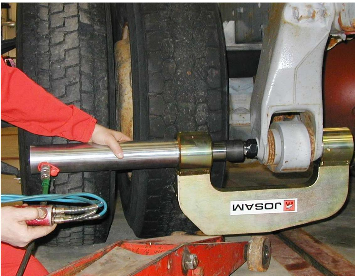
Данная модель предназначена для выпрессовки и запрессовки сайлентблоков грузовых автомобилей.
